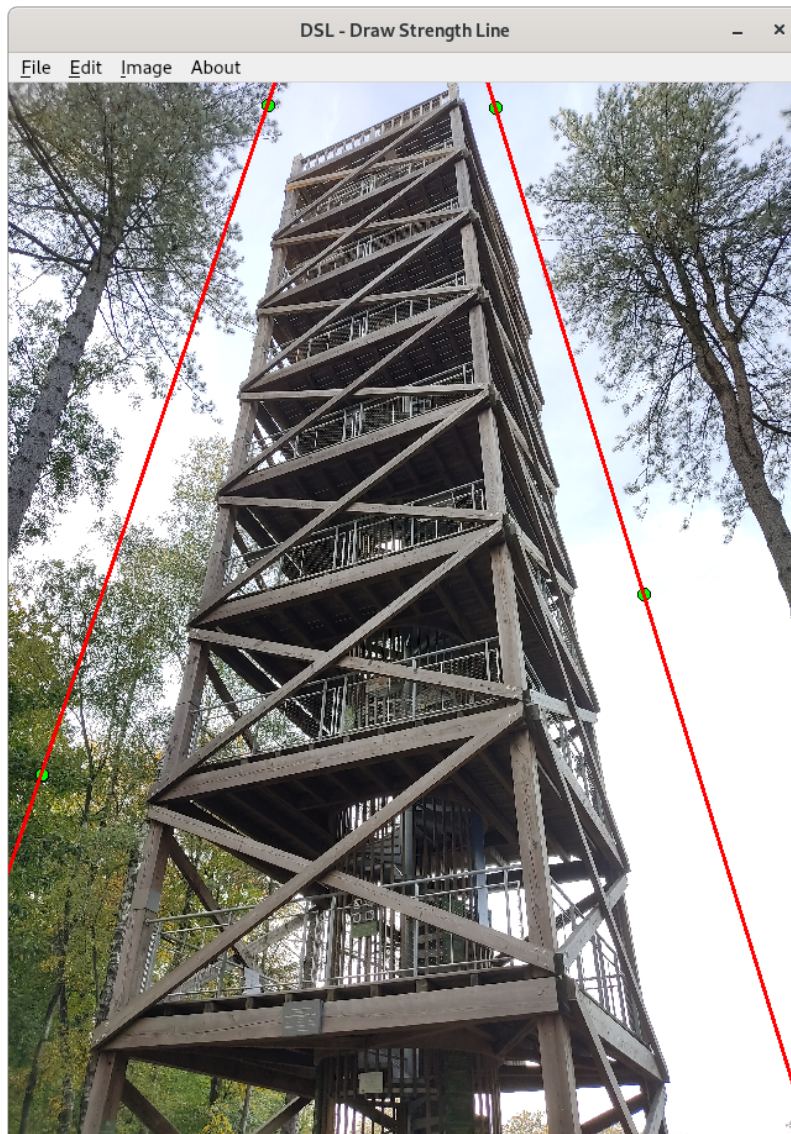
FIGURE 5 – Image avec deux lignes tracées. Les lignes sont paramétrées par les cercles verts qui peuvent être déplacés.
